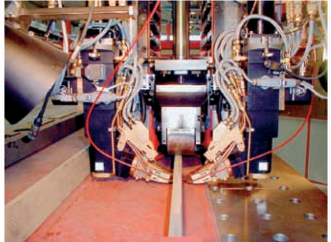
Soudage de joints en T
